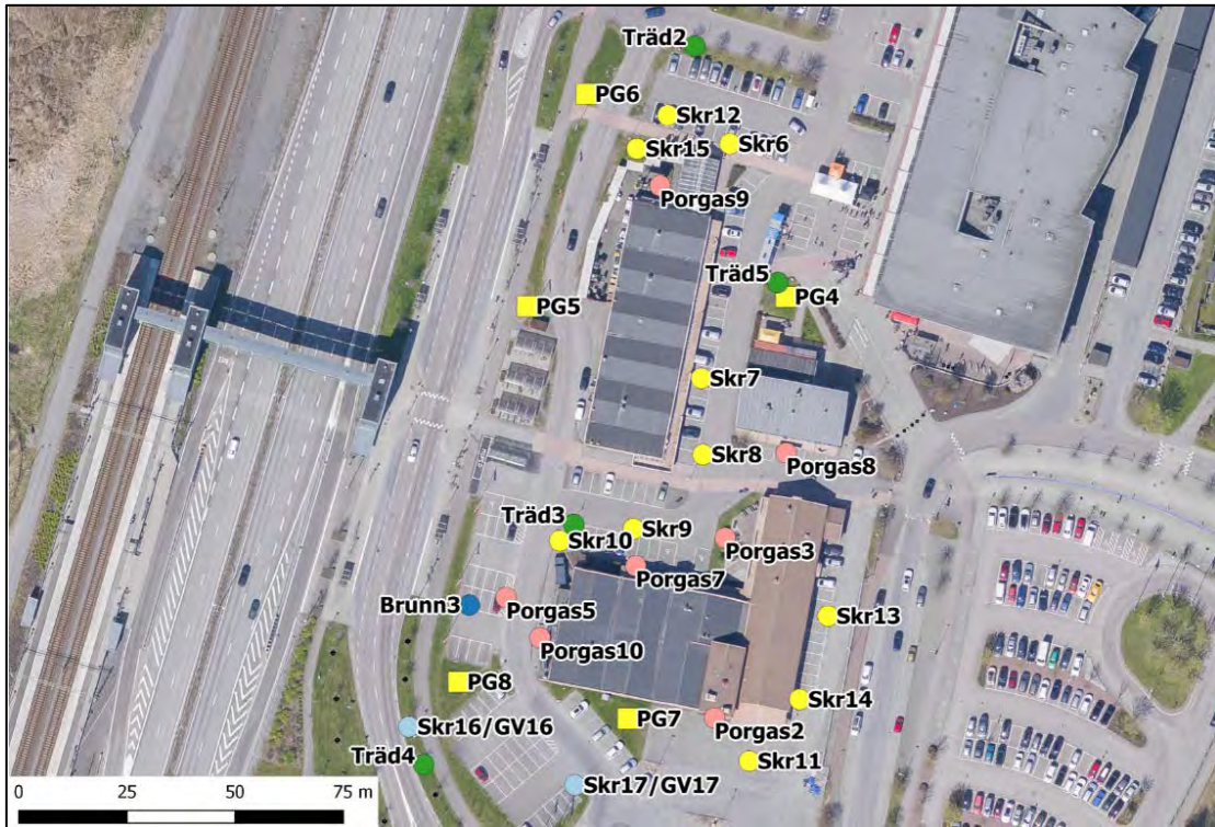
Figur 4. Provpunkter inom delområde 2. Grundvattenrör installerat i Skr16/GV16 och Skr17/GV17.
