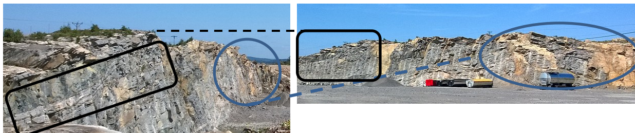
Figur 3. Undulerande foliationsplan med flack lutning närmast bergsklacken (svart) och brantare lutning i norr (blått).
