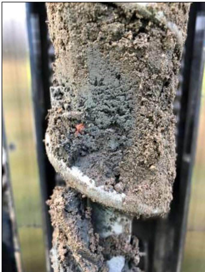
Figur 10. Rester av tegel i provpunkt 20AF03MP. Foto: AFRY.
