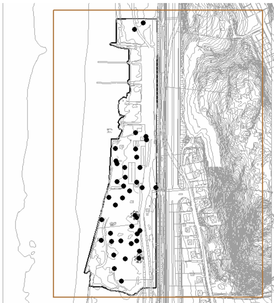
Figur 3.3 Okulärt bedömd förekomst av massor med oljerester vid provgroppgrävning.
