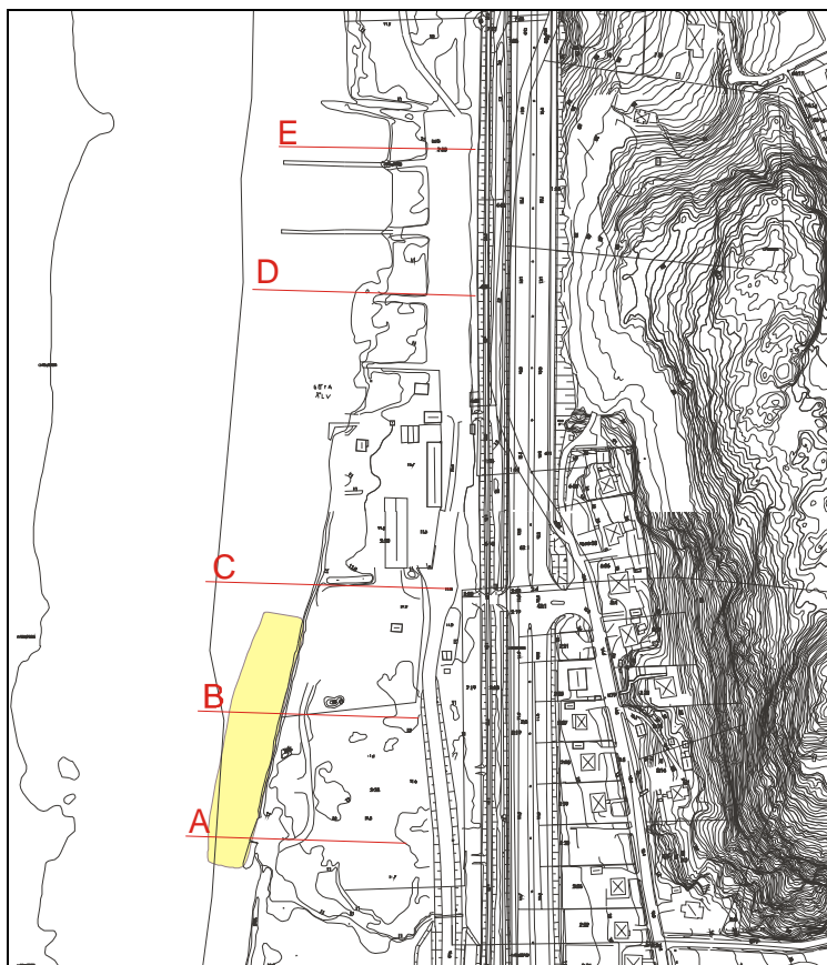
Figur 4.1 Föreslagen tryckbanks utbredning i plan inom Område III, från detaljerad stabilitetsutredning (bilaga 16).
