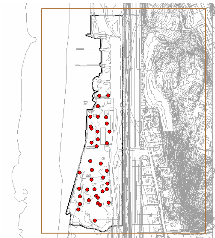
Figur 3.2 Okulärt bedömd förekomst av massor med avfallskaraktär, av större omfattning, vid provgröpsgrävning.
