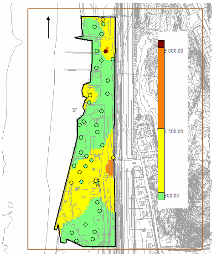
Figur 3.4 Blyhalter (analyser och XRF-mätningar) i ytliga (ca 0 – 1 m) fyllnadsmassor
