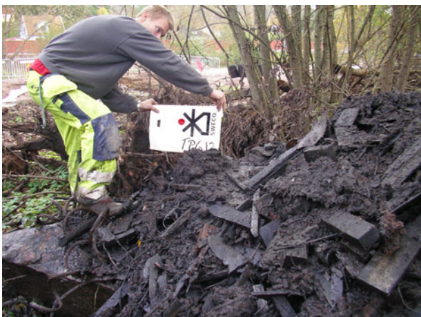
Uppgrävda fyllnadsmassor från TPg 0612 med oljerester, trä och skrot.
