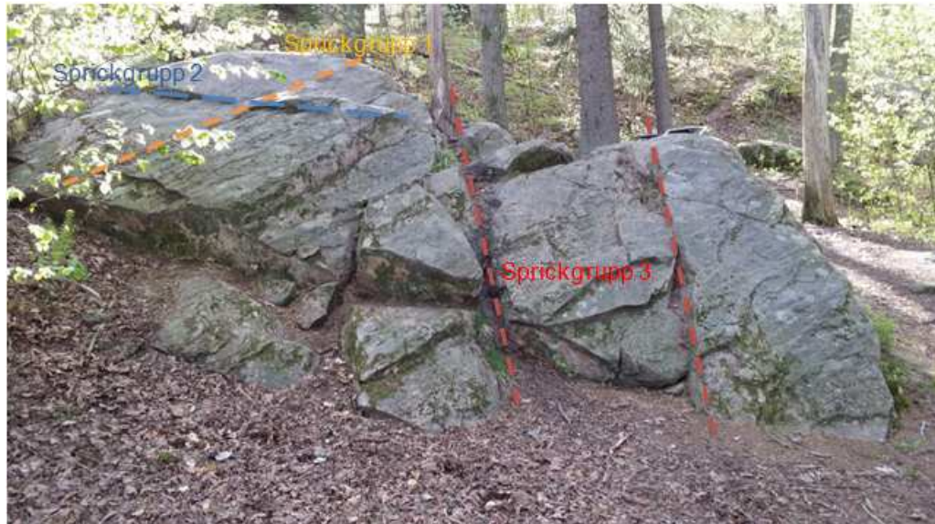
Figur 9.1. Område inom fastighet 5:40, där de olika sprickgrupperna är markerade.
