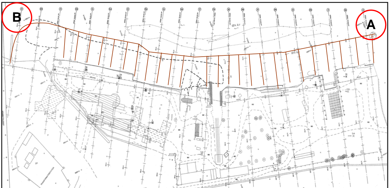
Figur 4. Karta över Bohus varvs saneringsområde. Brunt streck visar läget för släntlutning för stödfyllning och erosionsskydd i Göta älv. Uppströms mätpunkt (A) och nedströms mätpunkt (B) är markerade.
