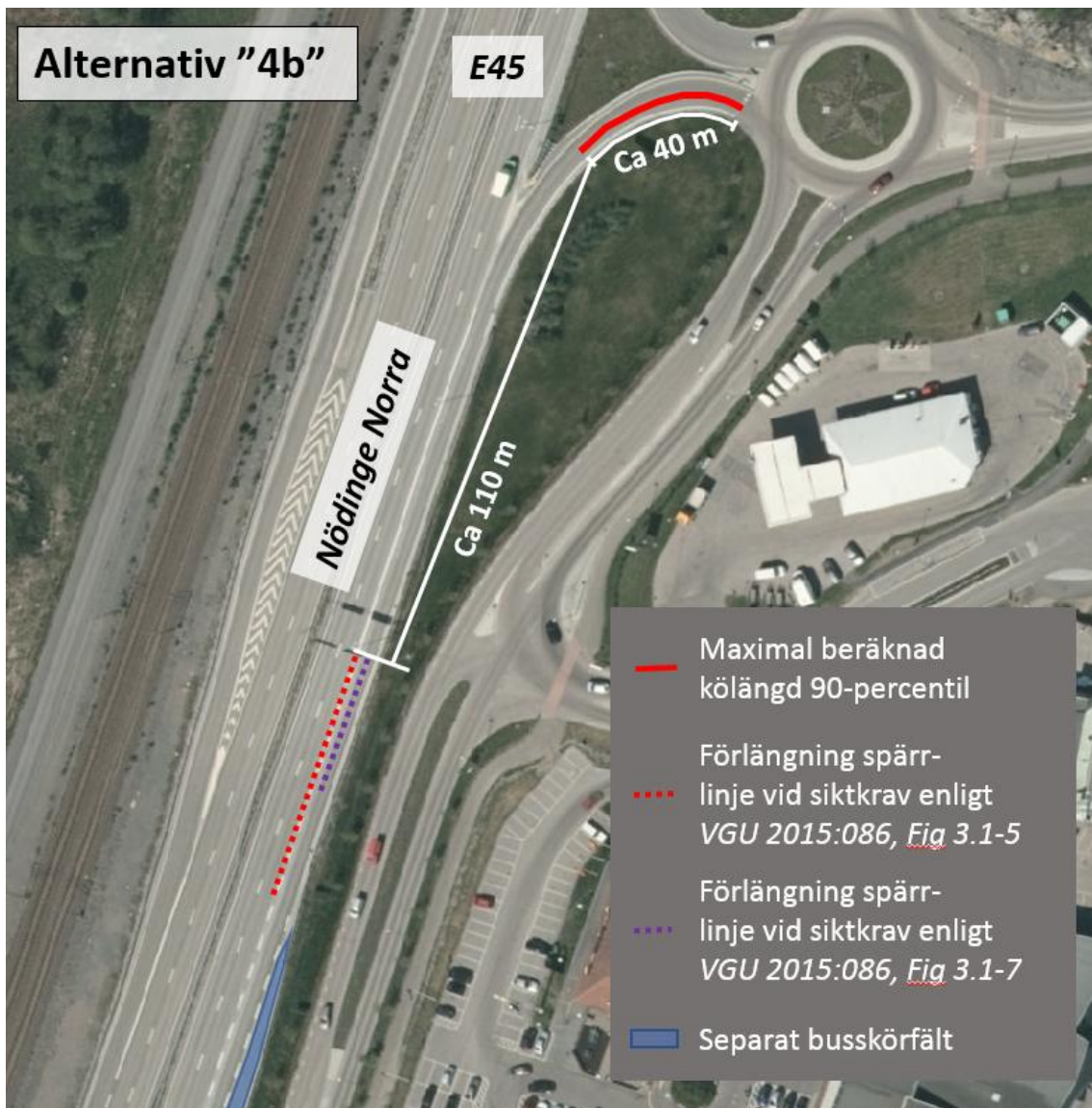
Figur 10 Översikt beräknad kölängd samt förlängning av spärrlinje med utformning enligt alternativ 4b.
